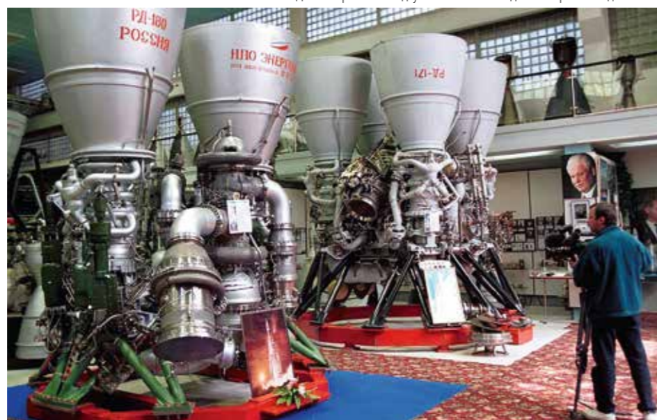
РД-180 – российский двухкомпонентный жидкостный ракетный двигатель.
