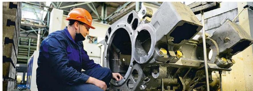
Для холдинга «Татэлектромаш» (г. Набережные Челны) металлурги с прошлого года ведут отливку основных корпусных деталей двигателей электровозов. Дополнительно в марте были заключены договоры на их механическую обработку.
