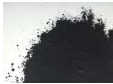
Карбид титана для контакторов и напыления
