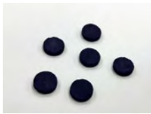
Термокотоды из гексаборида лантана для электронно-лучевой сварки
