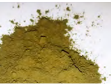
Нитрид циркония для напыления на сопла реактивных двигателей
